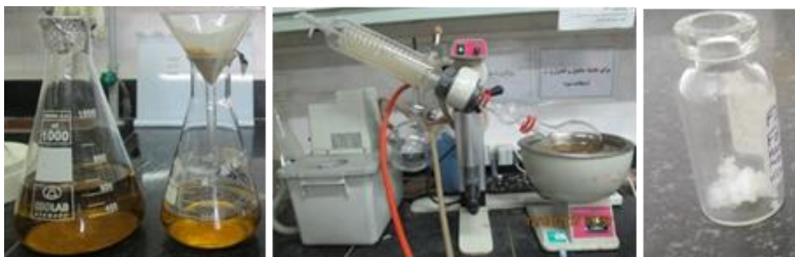
شکل ۱- عصاره‌گیری از بره موم با استفاده از اتانول و تغلیظ توسط دستگاه تبخیر دوار (Rotary evaporator)
