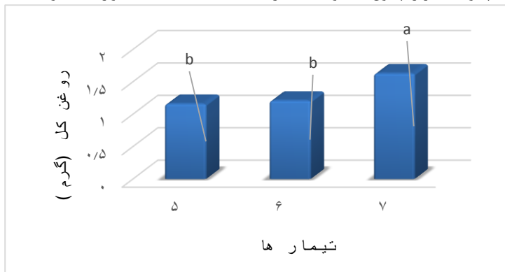
شکل ۳- مقایسه میزان روغن کل ریزکپسول‌های تولیدی با درصدهای مختلف هسته به دیواره (۵، ۶ و ۷).
